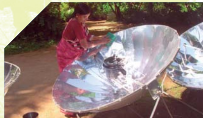
Desenvolupament de tecnologies apropiades a l'àrea de Vedanthangal (Índia) per la Universitat Politècnica de Catalunya: cuina solar.
